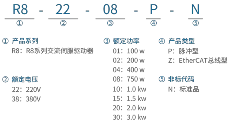
图 2-2 伺服驱动器型号标识
