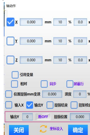
图 3 轴运动到位置输出 Y 信号
