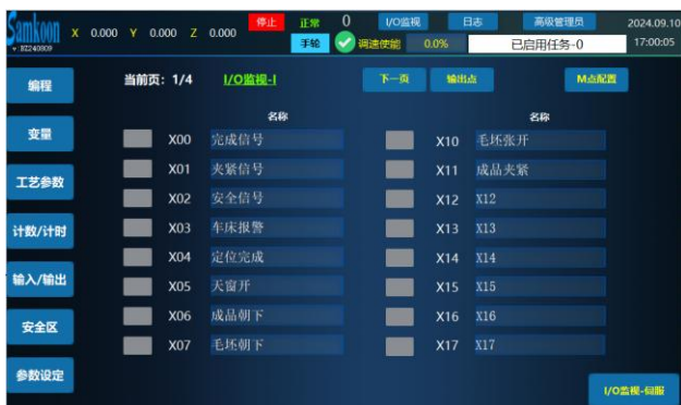
IO 监视-输入点 X 点 (点 M 点配置进入右侧图)
