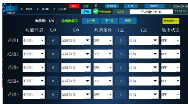
根据输入点通断进行判断输出点通断功能
