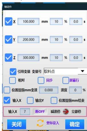
图 2 感应到 X 信号停止
