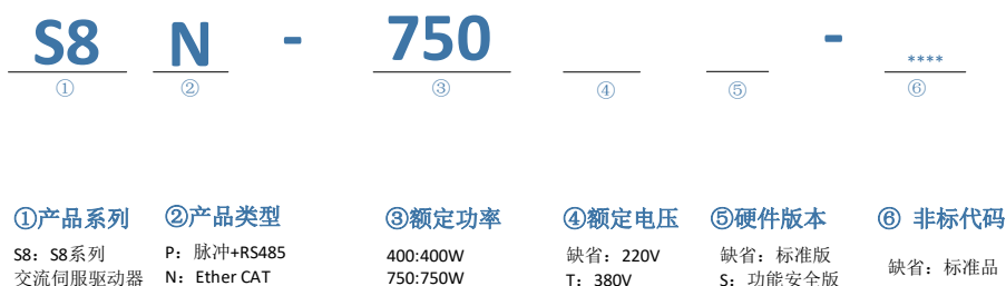
图 2-2 伺服驱动器型号标识
