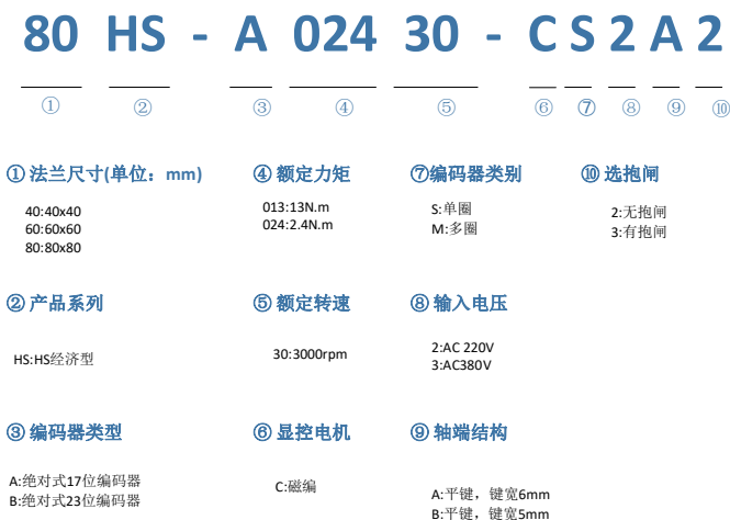
图 2-8 电机型号标识
